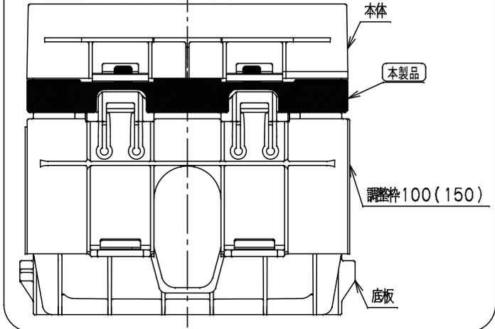
使用方法② (A部無し) : 調整枠100 (150) の下に装着する場合
