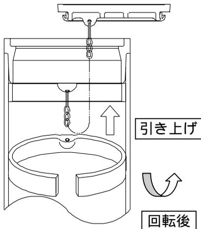
引き上げ後、鎖後付リングを立上り管に押しつけるとより接着が確実になります。
