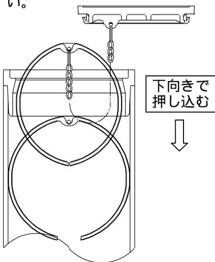
接着部奥まで入れた鎖後付リングを回転させて水平にし接着剤を塗布したところまで引き上げて下さい。
